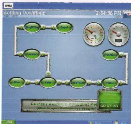
Schermata di supervisione del downtime di impianto
