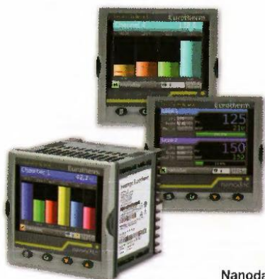
Nanodac, registratore/regolatore che combina formidabili capacità di registrazione videografica con controllo, comunicazione e reportistica estremamente versatili
