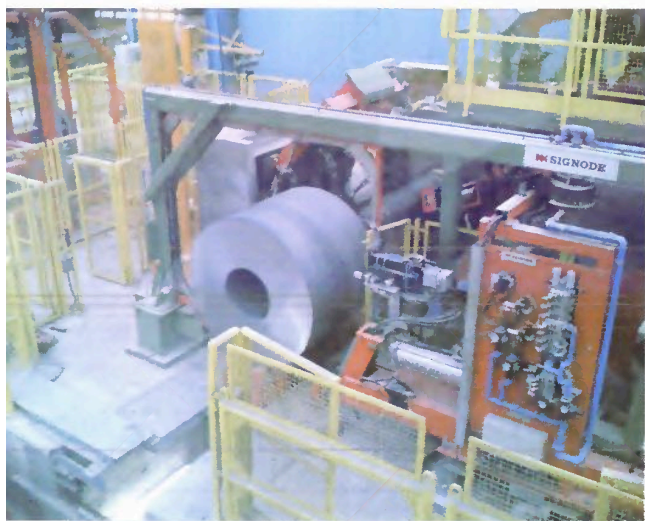
FIG|02 Un altro aspetto della linea: la sezione d'imballaggio (reggiatura) dei coil in uscita dalla linea.
