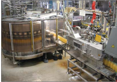
An den Hochleistungsfüllern werden die Gläser in Höchstgeschwindigkeit abgefüllt
