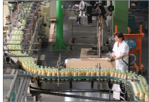
Im Fraktalbereich „Verpackung“ erfolgt die Etikettierung, Tray-Konfektionierung und Palettierung
